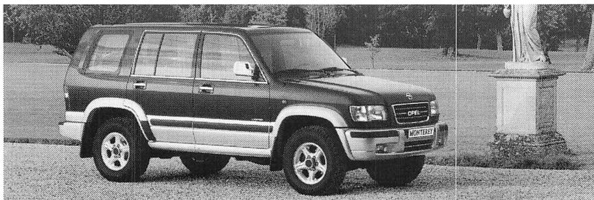
Der Monterey geht neue Wege. 5- oder 3türlich. Mit neuentwickeltem 3.0-DTI-Turbodiesel-Motor mit 16 Ventilen, «Common-Rail»-Einspritztechnik und 117 kW (159 PS) oder dem neuen 3.5i V6 24V Motor mit 158 kW (215 PS). Neu ist auch das «No-Stop-Allrad-System». Zugelegt hat der Monterey zudem bei der Fahrsicherheit, beim Komfort und bei der Anhängelast (bis 3300 kg). Nur nicht beim Preis.
